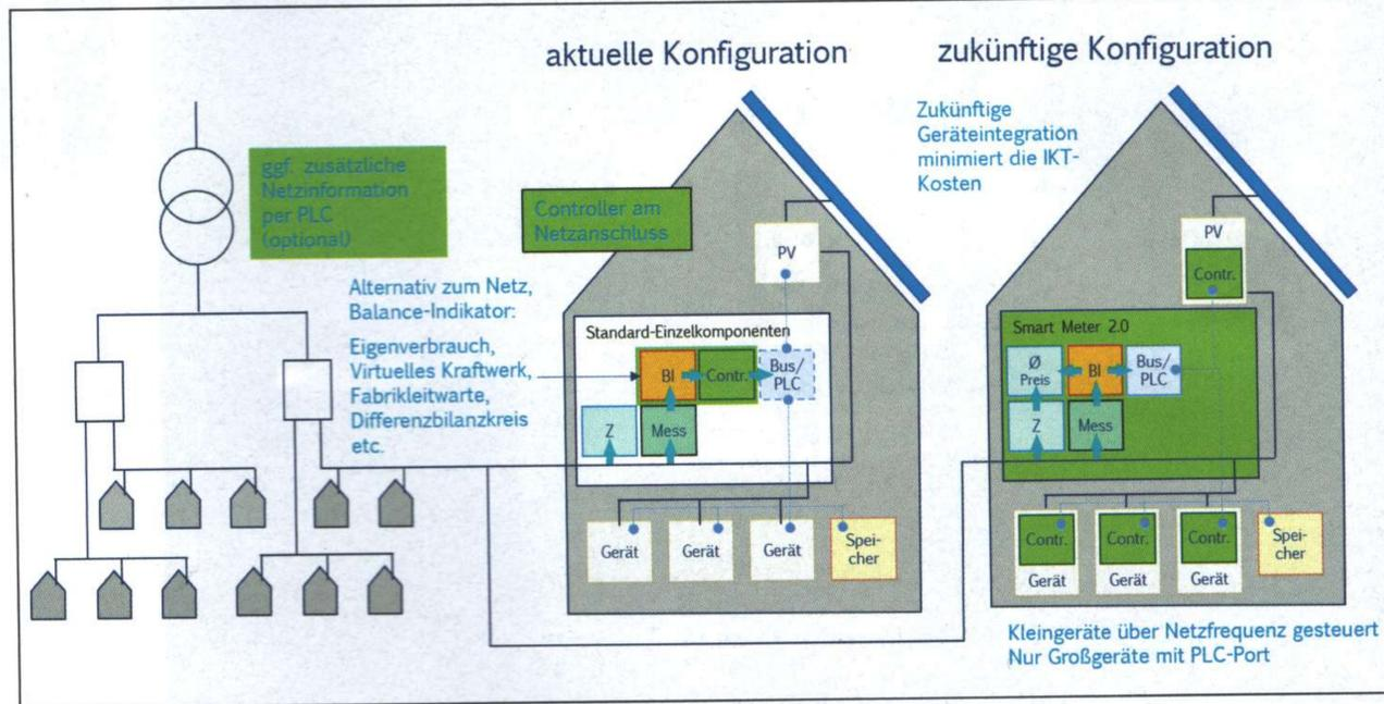
Bild 1. Entwicklung der Hardwarekonfiguration vom Digital Twin zu Embedded Controllern
