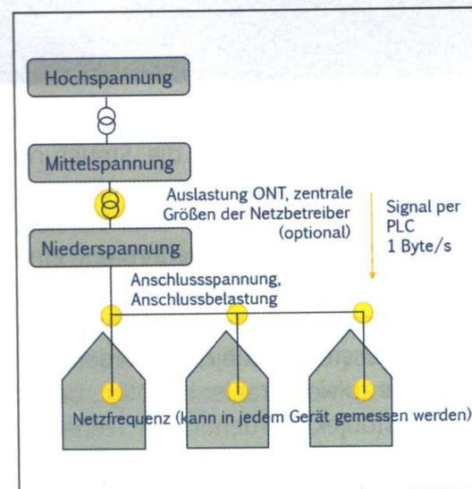
Bild 2. Messpunkte für Netzzustandsgrößen
