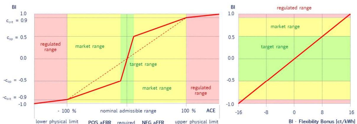
Abbildung 28: Beispielhafte Bildung des Balance Indicator und des Flexibilitätsbonus aus der Regelzonenabweichung (ACE)
