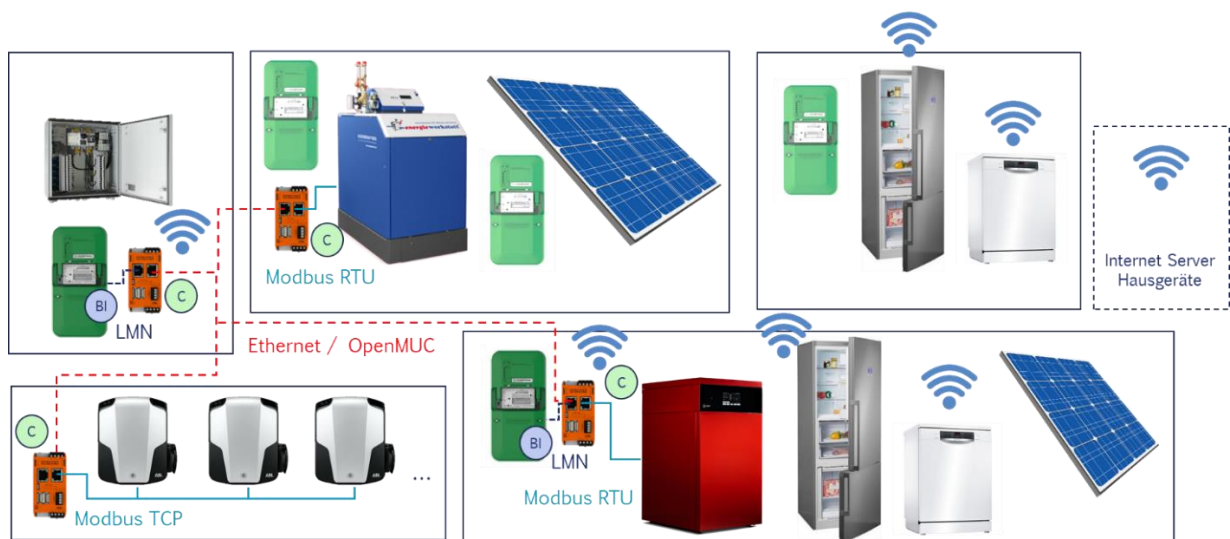
Abbildung 12: Ausgestaltung der IKT zur Gerätesteuerung in SoLAR
